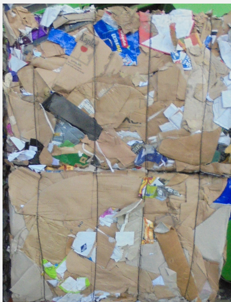
Slika 6 Balirani karton i papir izdvojeni iz otpada
