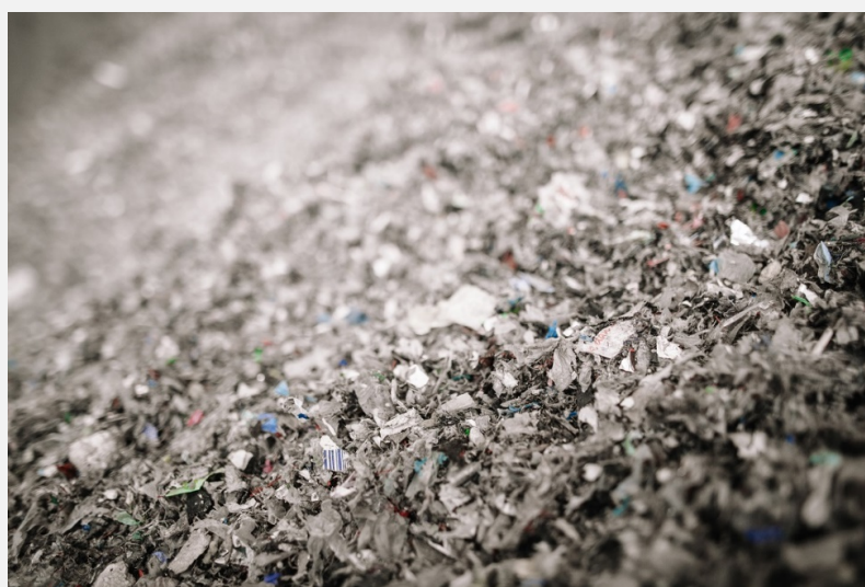
Slika 2 Alternativno gorivo iz otpada za upotrebu u cementarama
