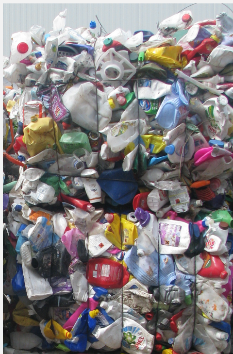
Slika 4 Balirana HDPE plastika izdvojena iz otpada
