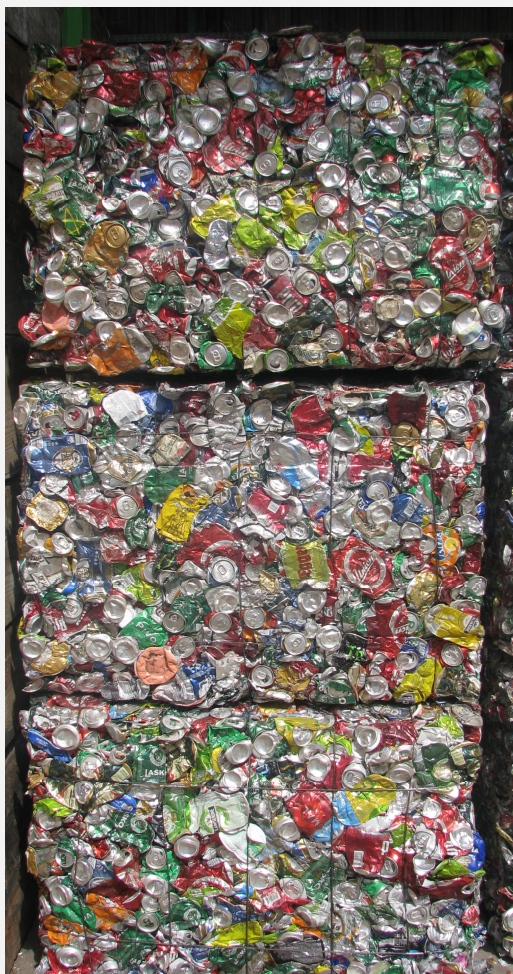
Slika 3 Balirani aluminijum izdvojen iz otpada
