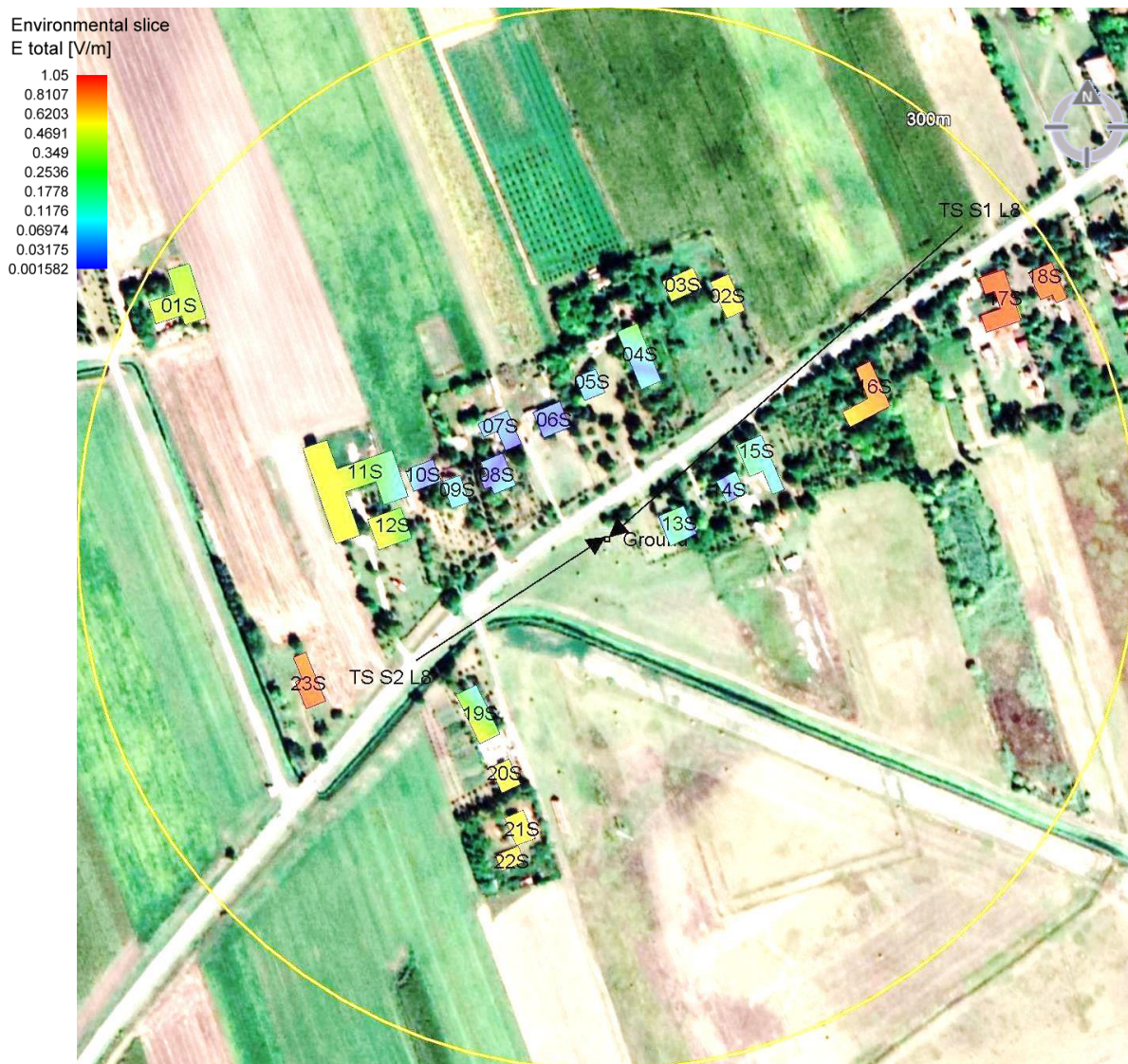
Slika 6.12. Jačina električnog polja radio-sistema LTE800 bazne stanice „SOU73, SOO73 SOMBOR OBZIR” operatora „Telekom Srbija“ na nivoima najizloženijih spratova
