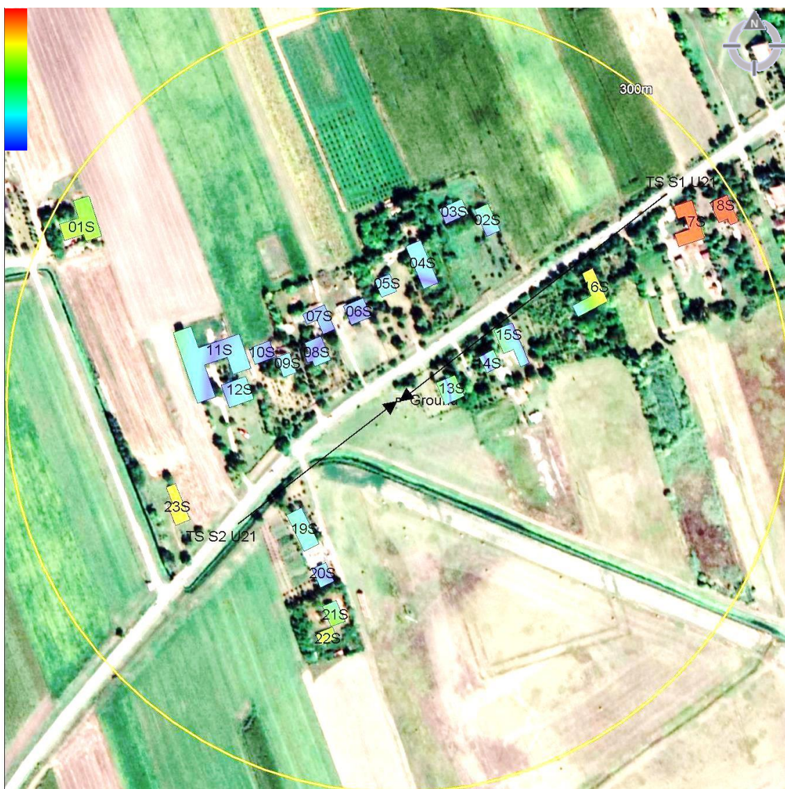
Slika 6.11. Jačina električnog polja radio-sistema UMTS2100 bazne stanice „SOU73, SOO73 SOMBOR OBZIR” operatora „Telekom Srbija” na nivoima najizloženijih spratova
