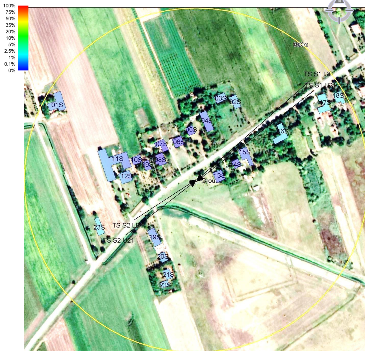
Slika 6.13. Izloženost od radio-sistema UMTS2100 i LTE800 bazne stanice „SOU73, SOO73 SOMBOR OBZIR” operatora „Telekom Srbija” na nivoima najizloženijih spratova
