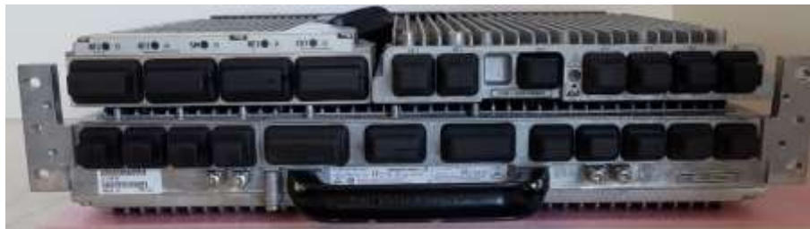
Slika 3.3 Izgled FSME sistemskog modula
