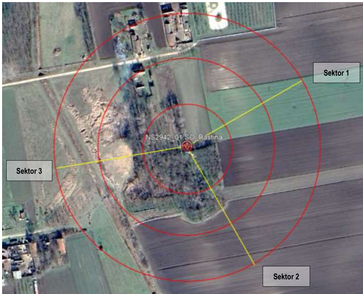
Slika 2.4 Pravci zračenja antenskih sistema predmetne bazne stanice
