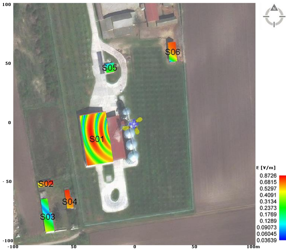
Slika 6.11. Rezultati proračuna jačine električnog polja u objektima kada sistem LTE1800 operatera „Cetin“ d.o.o. radi maksimalnim kapacitetom
